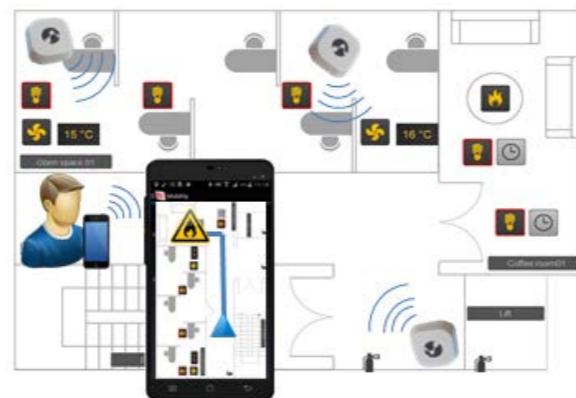
L'application mobile de PcVue Solutions adapte automatiquement l'affichage des informations en fonction de l'identité de l'utilisateur et de sa position
